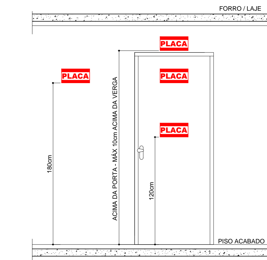
✓ DETALHE INSTALAÇÃO DAS PLACAS DE SINALIZAÇÃO SEM ESCALA
